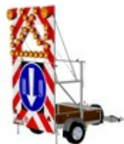
Fahrbare Absperrtafeln für Autobahnen
