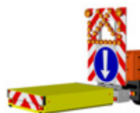
Fahrbare Anpralldämpfer TMA
